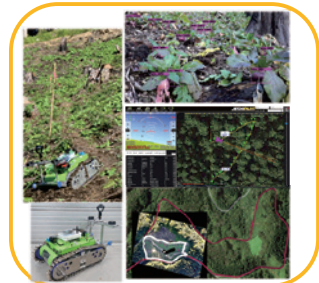
中山間地域において、RTK-GNSSを使っ た高精度位置情報を基に、急傾斜対応の ロボットを自律走行させ、撮影した温海 かぶの写真にどのくらい作物が発見され たか、ディープラーニングを使った生育 分析を実施
